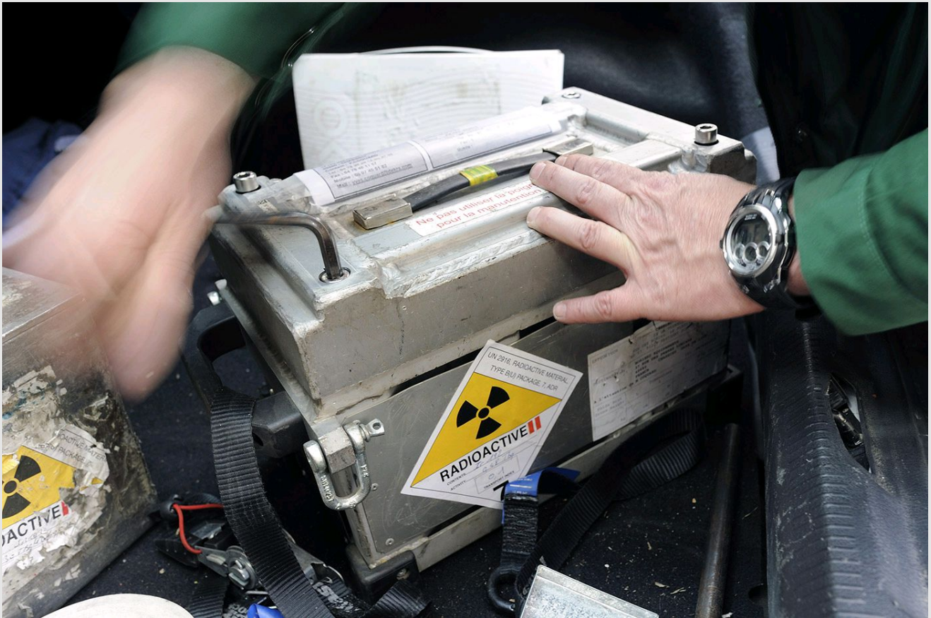
Matériel portable de radiographie contenant une source de rayonnement ionisant
