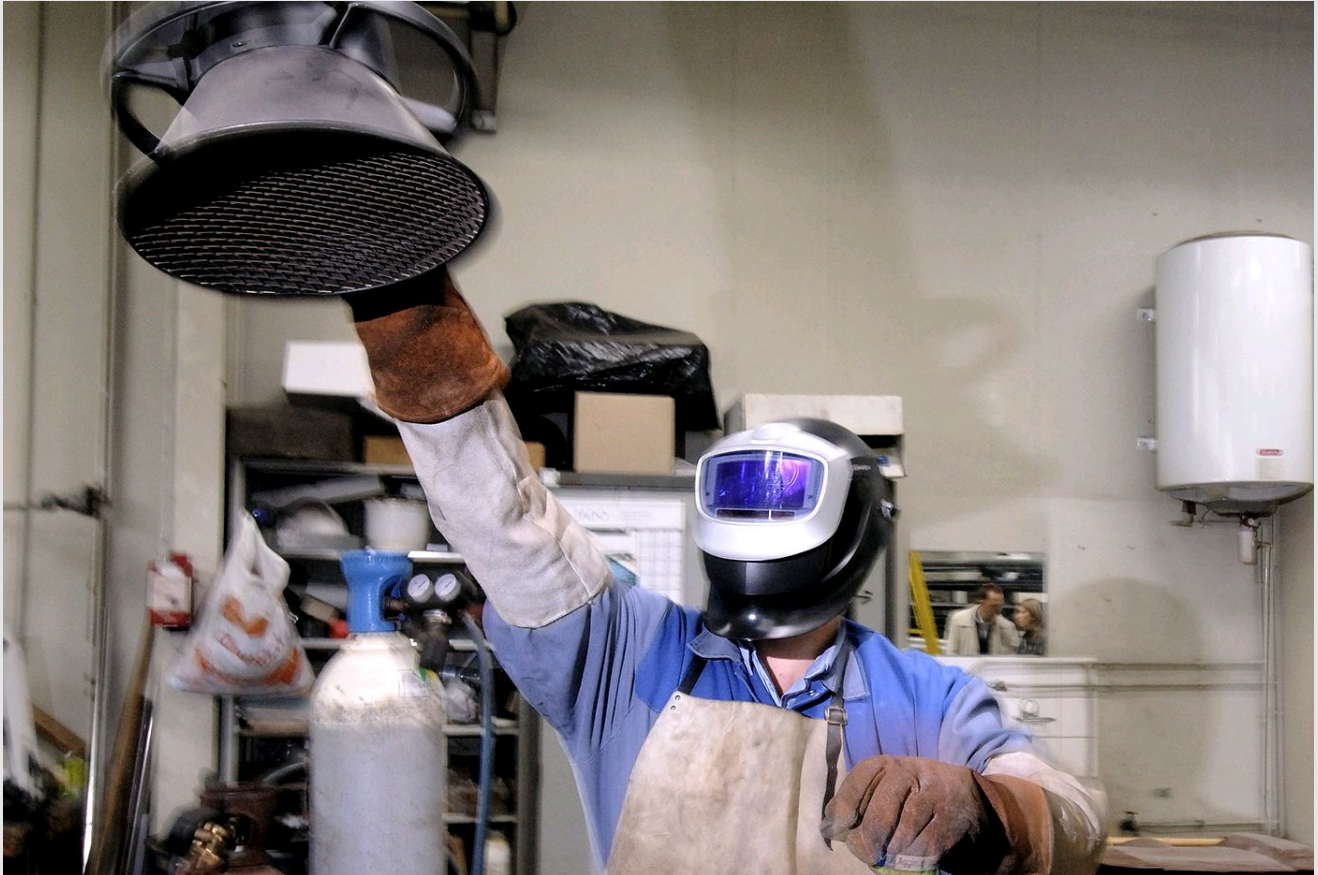
Port de casque à ventilation assistée sur un poste de soudage (oxycoupage) pour protéger des expositions aux HAP reconnus cancérigènes
